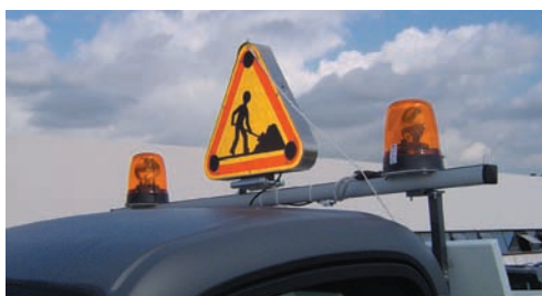
Verkeersbord 'werkzaamheden' met twee zwaailichten)
